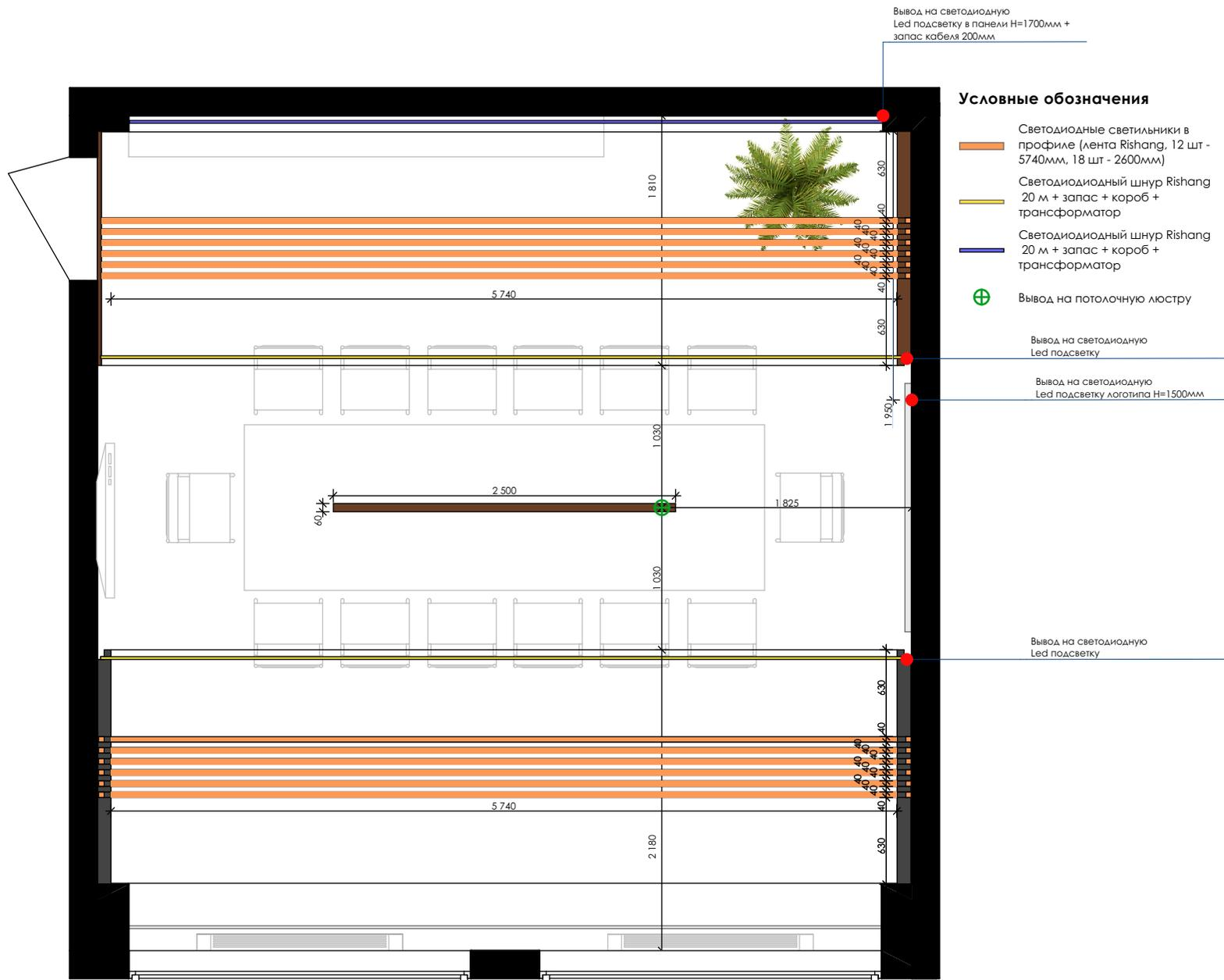
Схема освещения с размерами
